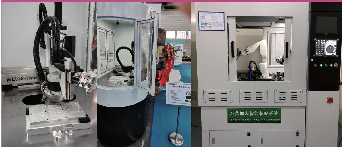
**仪器简介** 精密装配对位仪及以精密对位为核心技术的精密装配平台, 该类平台已推广应用到10多类精密、微细、复杂机电系统柔性自动化、智能化装配中。其中核心模块精密同轴对位模块、高精度装配机器人模块均可作为单独使用的仪器与其他装置组成精密装配系统。
