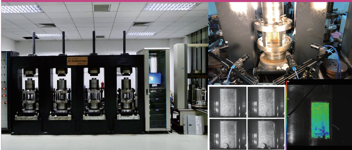
软岩水-力耦合的流变损伤多尺度力学试验系统
