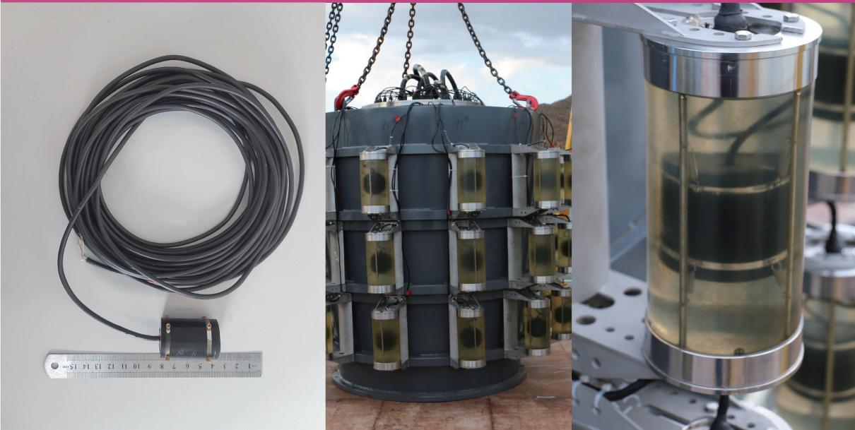
**仪器简介** 声纳设备关键部件是水听器,它是感知水下声波声压P大小的传感器。声纳探测能力依赖于声纳阵处理增益,阵元个数越多,阵增益越高,功能越多,体积重量就越大。矢量水听器不仅感知水下声波的声压P,还感知质点振速矢量V,进而可以得到声波强度矢量。
