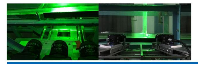
仪器简介 两相流高频粒子图像测速系统是在国家自然科学基金仪器专项基金资助下研发完成的流动测量成套装备。系统硬件选用行业领先的专用激光器和进口高速摄像机,集成粒子图像判读技术最前沿成果,研发成功具有自主知识产权的 Joy Fluid Measurement (JFM)系列高频粒子图像测速系统。该系列产品可测量平面二维、平面三维或立体三维流场,的空间分辨率可达 50um,空间测量范围 10 厘米到 1m 可调,采样频率从 1Hz 到 1000Hz 可调,可同步获得流场和固相颗粒或气相气泡的速度。系统各项技术指标达到国外同类产品的先进水平。
