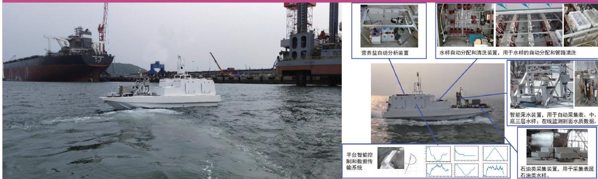
**仪器简介** 针对海洋环境监测中急需的常规监测船不能完成的复杂浅海域生态环境参数监测难题,研制自动水样采集检测系统、自动水样分配及存储系统等关键设备,并集成多参数水质分析仪、营养盐在线分析仪等水文和气象分析单元,形成国际上首台复杂海域多要素智能无人在线监测系统。该智能无人在线监测系统能够对海洋生态环境水文、水质、生物等二十多种生态环境指标进行自动化检测,满足我国海岛调查、海洋监测、水文研究以及突发性应急事件处理需求,将对我国海岛调查、海洋监测、水文研究以及提升对突发性应急事件处理能力发挥重要作用。
