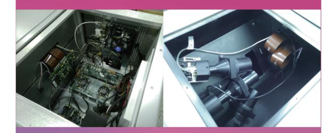
仪器简介 该仪器是基于压缩感知成像理论设计的压缩感知数据采集和重建的装置,可以提供任意 值测量矩阵的配置,用以验证不同的测量矩阵在光学成像中的实际效果;实现图像采集, 恢复,呈现一体化,能够让相关研究人员高效快捷地验证自己的恢复算法和成像效果。
