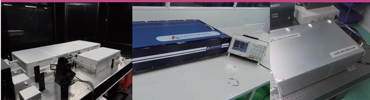
**仪器简介** 皮秒激光器具有高的峰值功率GW、窄的脉冲宽度脉冲宽度ps ( $10^{-12}$ s), 按频率分类主要产品包括百兆赫兹、赫兹、1百赫兹、千赫兹、100千赫兹皮秒激光器产品, 波长覆盖从紫外到红外, 脉宽从几皮秒到百皮秒, 是超短脉冲主要光源之一。
