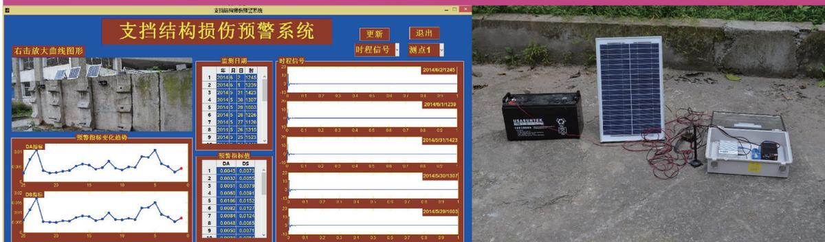
**仪器简介** 本仪器的基本原理是将环境荷载激励技术与小波包分析技术相结合，提取环境激励下支挡动力响应的小波包能量谱，计算损伤预警指标。采用环境激励的方式获得时域信号，通过4G通讯手段传输给远程计算机，再经软件分析，包括频率分析，小波包频带能量谱分析，对支挡结构进行健康诊断和损伤预警。仪器由上位机、下位机、无线采集模块组成。上位机完成远程遥测的功能；下位机完成节点管理及和上位机数据通讯的功能；无线采集模块完成数据采集的功能，包括加速度传感器、无线ZigBee 模块、系统电源等。
