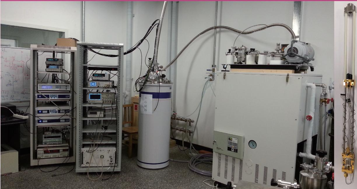
**仪器简介** 多功能磁电耦合效应测量系统,实现了在较宽温度区间(2 - 350K)、磁场范围( $\pm 12\text{T}$ )、电场范围( $\pm 3000\text{ V}$ )、频域范围(0 - 10 MHz)内对多种静态和动态磁电耦合效应进行精确的测量和表征。同时,该仪器也可以测量磁电阻,磁致伸缩,热膨胀,热电势等物理性质。该系统主要应用于凝聚态物理基础研究,也可以用于对磁电功能材料和应用器件背底噪音 $<5\mu\text{V}$ 的性能测试。
