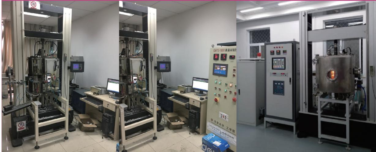
**仪器简介** 超高温极端环境力学性能测试系统包括1800°C有氧环境下材料力学性能测试设备和2600°C快速升温/多气氛/超高温力学性能测试设备。上述设备攻克了超高温有氧环境下发热量体和夹具设计与制备、接触式变形测量和非接触在位观测等技术难题,有氧环境下测试温度、升温速度、氧分压等关键核心指标已达到国际领先水平;已成功应用于多种超高温材料的力学性能表征和力学行为研究,发现了一系列的实验新现象,为行业部门提供了有效的数据支撑,为超高温材料的设计研发和工程应用起到了重要的指导作用。
