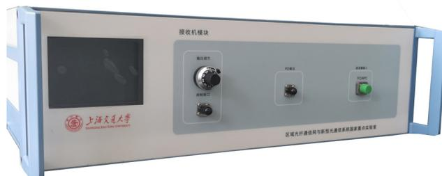
**仪器简介** 本仪器融合光波分复用、时分复用和时间拉伸等技术，采用光学采样、电学量化方式，突破电模数转换瓶颈，可对超高速非周期瞬态信号进行实时采集和处理。实时采样率和模拟带宽分别达到 150GSa/s 和 60GHz，适用于宽带雷达、电子对抗以及超高速通信与信息处理系统。
