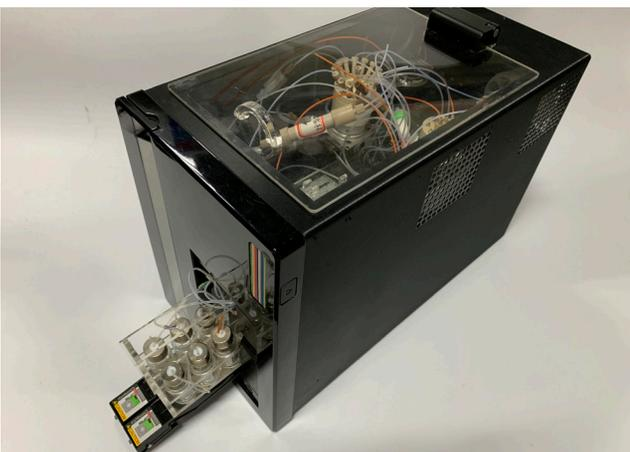
**仪器简介** 针对重大疾病可视化精准诊治中分子影像探针合成制备的挑战性问题，本项目建立了一种基于微流控芯片技术的模块化集成合成仪，仪器集成了微流控流体操控系统、反应控制系统、嵌入式电子控制系统、通讯及远程控制系统等。微流控流体自动操控系统是合成仪的核心，负责实现反应所需试剂的量取、驱动、装载、放射性试剂的上柱吸附、洗脱等以及产物的过柱分离纯化等复杂流体操作的自动化操作与控制。该系统主要由气液管路、微流控芯片、精密注射泵、多路分配阀、纯化芯片等部件构成。该系统可实现合成试验流程的编写和仪器运行远程控制及试验参数的远程监测。本项目多学科联合攻关，充分发挥微流控芯片合成技术在微小尺度下的高传质、传热等优势，突破其在快速蒸发、主动混合等方面的局限，实现了超微量分子影像探针的快速合成，同时采用微流控芯片模块化策略，实现了不同分子影像探针在同一台仪器上的合成，成功研制了国内首套具有完全自主知识产权的“PET 分子影像探针微流控模块化集成合成系统”。
