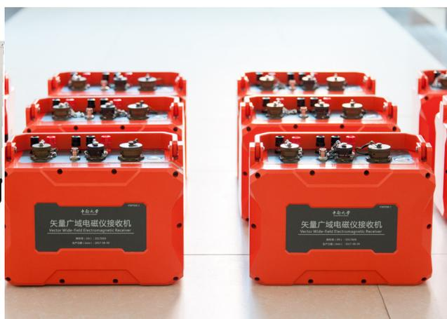
**仪器简介** 三维矢量广域电磁仪器系统由大功率发射机、发射机控制器，2通道、5通道和8通道电磁采集站组成，可在工作区内，按一定比例尺布置数百台不同分量电磁数据采集站，形成固定的三维接收网格；在离工区一定距离上先后布置3个以上不同收发距、且方向不同的接地导线，并依次向地下供包含多个主频率的伪随机信号电流，接收站同步测量2个相互正交的水平电场分量（部分测点上同时测量3个磁场分量），并进行长时间（4-8h）全波形采集，在每个测点上获得多个收发距的高精度电（磁）场矢量，从而形成真正的三维电磁场全息测量。
