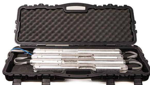
**仪器简介** 复杂山地多波宽频带地震数据采集系统是一种适用于山地勘探的地震数据采集仪器。系统由分布式地面采集和微 VSP 井中采集两部分构成，包括三分量数字检波器、无线 / 有线采集节点、千兆 / 百兆交叉站、震源信息记录仪等系列设备，无线 / 有线混合组网，兼容无缆存储式采集，可快速构建三维、网状、蛇形等多种高速数据链路，以适应山地勘探复杂施工环境。系统融合了 MEMS 微弱信号处理、宽频地震采集、惯性姿态检测、方位校正等多项专利技术，具有检波器硬件定向、三维在线监控、自适应动态地址分配等特色功能，非常适合复杂山地多波多分量地震勘探。
