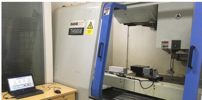
**仪器简介** 激光六自由度误差同时测量仪以光纤耦合的双频激光为测量基准，结合了激光干涉与激光准直测量技术，由激光器、测量头、靶镜以及测量软件组成。只需一次安装调整，即可实现单直线轴六自由度误差的同时测量，极大提高了机床校准效率。直接测量，无需解耦，无需更换附件及重新调整仪器，加上短的测量时间，使其保持高综合测量精度。已获得授权的美国专利和欧洲专利各一项，以及多项中国发明专利，拥有完全自主知识产权。
